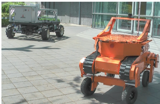
写真1 地上走行型の偵察ロボット（右）、 放水ロボットの走行機構部分（左奥）の展示
